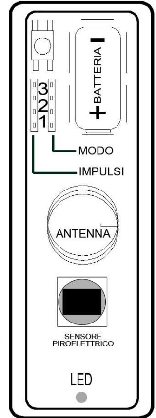
In normale funzionamento, dopo la trasmissione di allarme, il sensore entra in interdizione per circa 3 min. per salvaguardare la pila. Il test disattiva l'inibizione.
